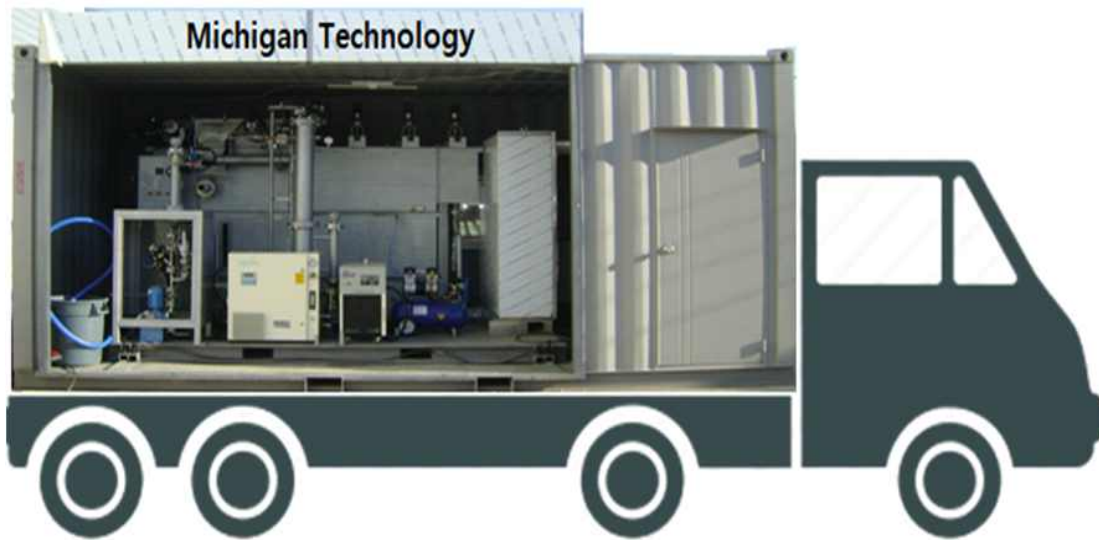
그림 6.2. 이동식 DOF (DAF) 시스템
